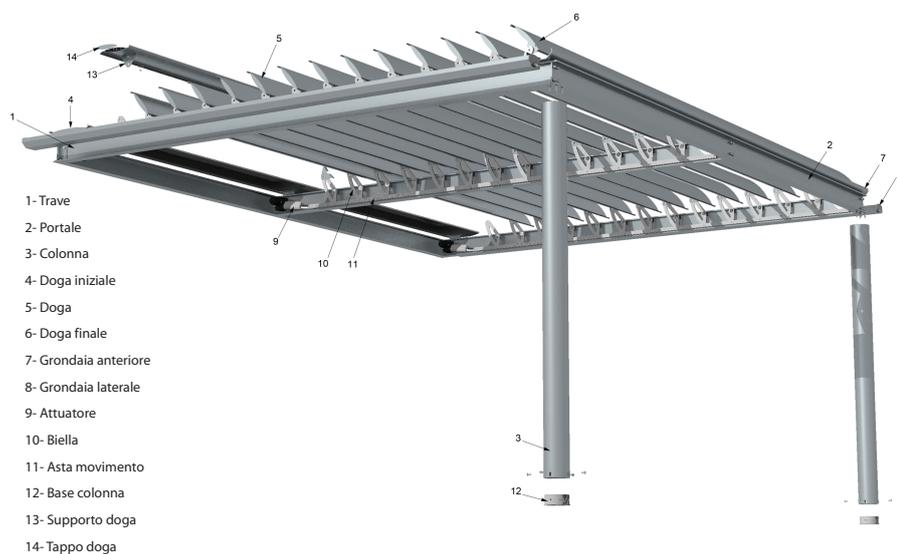
**Struttura** piana addossata a parete realizzata interamente in lega di alluminio 6082 T6 verniciato a polveri poliestere per esterno e composta da travi IPE 70x150mm sostenute da portali con colonne a sezione tonda Ø 150 mm. complete di piastre a scomparsa di ancoraggio al pavimento.
