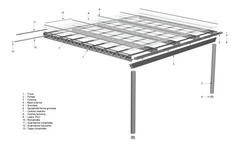
Struttura addossata a parete realizzata interamente in lega di alluminio 6082 T6 verniciato a polveri poliestere per esterno e composta da travi IPE 70x150mm alleggerite con fregi decorativi raccordate da traversi di sostegno Ø 35mm. e sostenute da portale con colonne a sezione tonda Ø 150 mm. complete di piastre a scomparsa di ancoraggio al pavimento.
